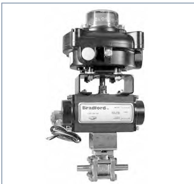
На изображении автоматизированный герметичный двухходовой шаровой кран 1/2 дюйма с концевым соединением под приварку Dixon, приводом с возвратной пружиной и NEMA 7 (взрывобезопасным) концевым SPDT выключателем с двумя бесконтактными переключателями и электромагнитным клапаном NEMA 7 с креплением NAMUR на 24 В постоянного тока.
