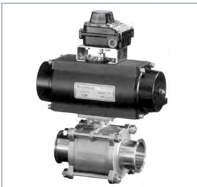
На изображении автоматизированный герметичный двухходовой шаровой кран 2 1/2 дюйма Dixon с приводом закрытого положения при отказе с возвратной пружиной и концевым выключателем NEMA 4/4X с двумя механическими SPDT переключателями.
