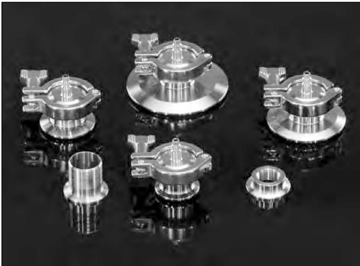
Обратные клапаны продувки воздухом Dixon предназначены для очистки линий трубопровода от продуктов трубопроводной транспортировки или СІР растворов, тем самым способствуя защите линий трубопровода от коррозии. Функция перехода в открытое/закрытое положение клапана при отказе предотвращает обратный поток с помощью простого механизма открытия при помощи воздуха и закрытия при помощи пружины.
