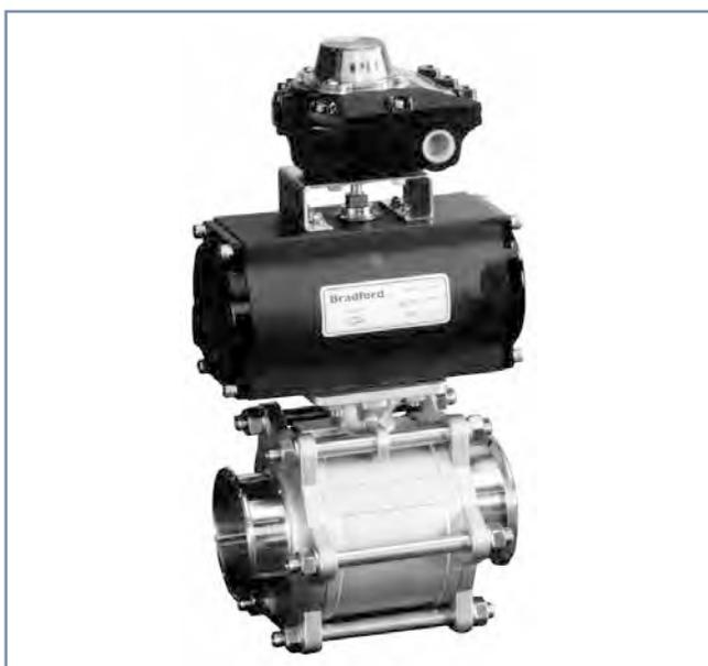
На изображении автоматизированный герметичный шаровой кран 3 дюйма Dixon с приводом двойного действия прямого монтажа (нормально разомкнутый) и NEMA 7 (взрывобезопасный с двумя механическими переключателями) концевым SPDT выключателем.
