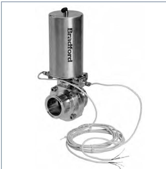
Автоматизированный дисковый затвор с вертикальным корпусом и приводом с функцией открытия при помощи воздуха - закрытия при помощи пружины при отказе и бесконтактными датчиками. **B5101S200CC-MI**
